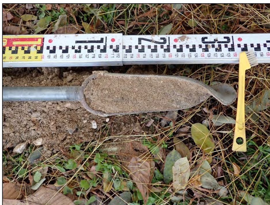
図 42 0ZK-0c2 地点の火砕流堆積物に覆われる礫まじり砂層
