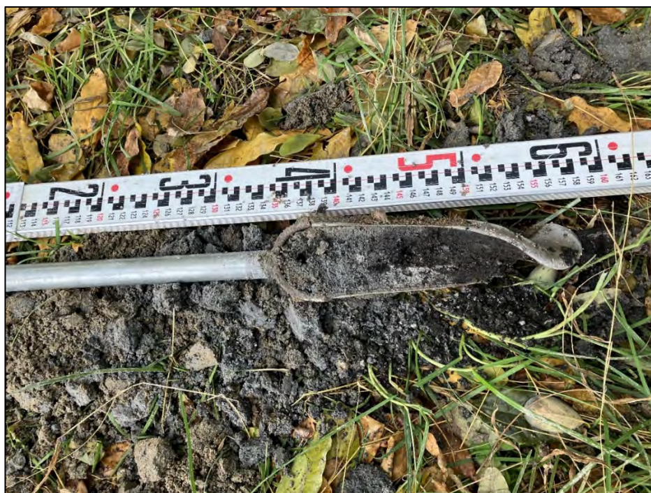
図 39 OZK-0c1 露頭の火砕流堆積物に覆われる腐植質シルト
