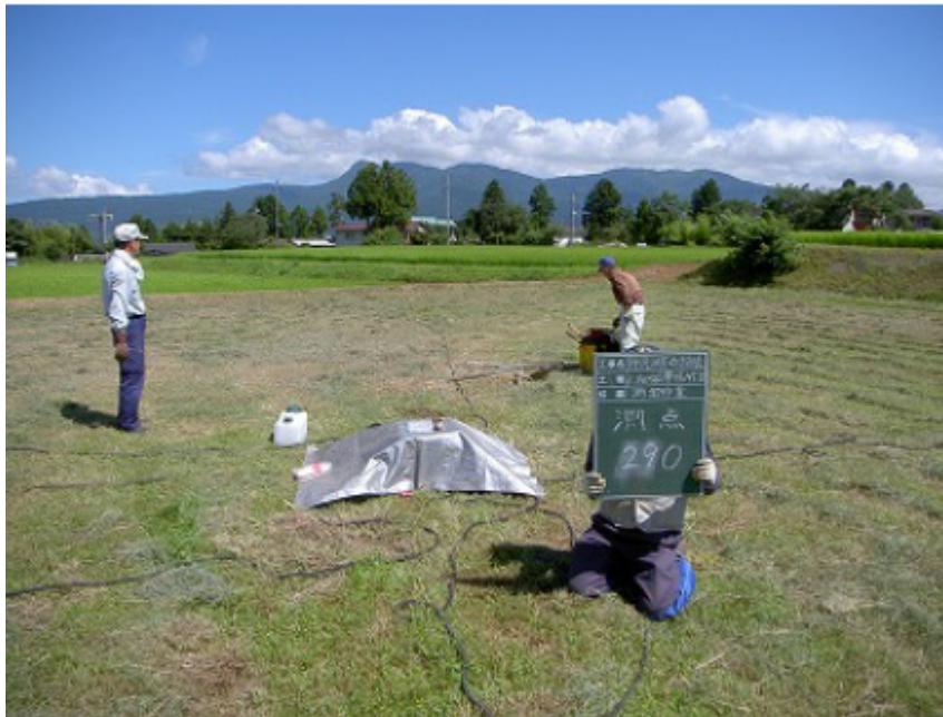
図2 観測風景（観測点290）。中央のビニールシートの中にアンプ・レコーダがあり、水平電場2成分および、磁場3成分の計測用のケーブルがつながっている。電極および磁場センサーは埋設されている。
