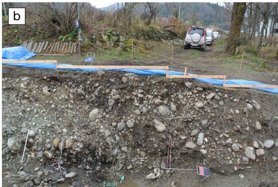
大出地区におけるトレンチ調査。(a) 低位段丘面における逆向き低断層崖とトレンチ（南向きに撮影）。(b) 西に傾いた農道とトレンチ南面に露出した断層帯（南向きに撮影）。
