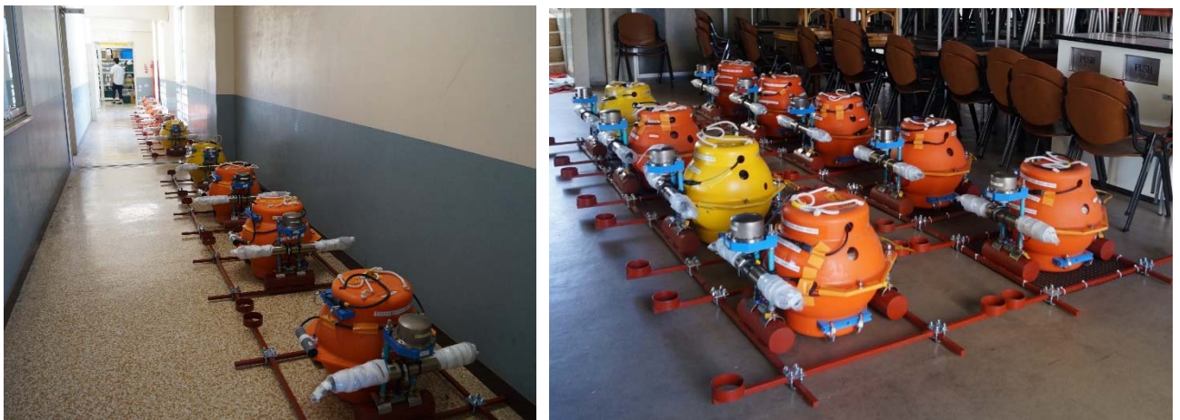
図1 本事業で整備され、組み立てられた OBS の様子。
