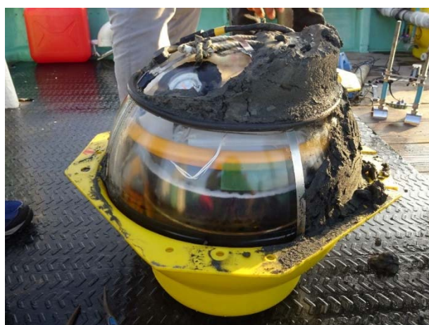
図 9 投入位置より南東方向に移動が確認され、回収された FUJ04F の状況。泥が大量に付着している状況から海底で押し流されたことが推測される。
