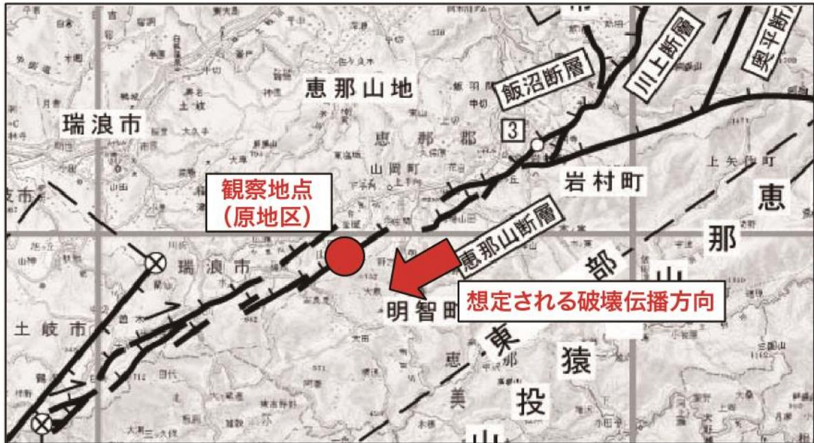
図 118 屈曲した条線から推定される恵那山断層における破壊伝播方向
