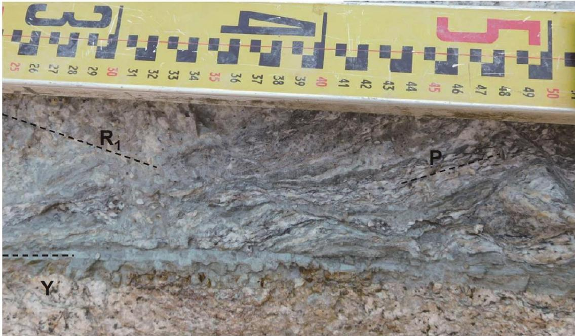
図 26 東白坂トレンチの底面で観察された猿投山北断層の複合面構造
