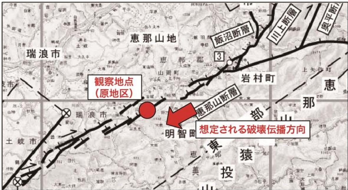
図 29 屈曲した条線から推定される破壊伝播方向
