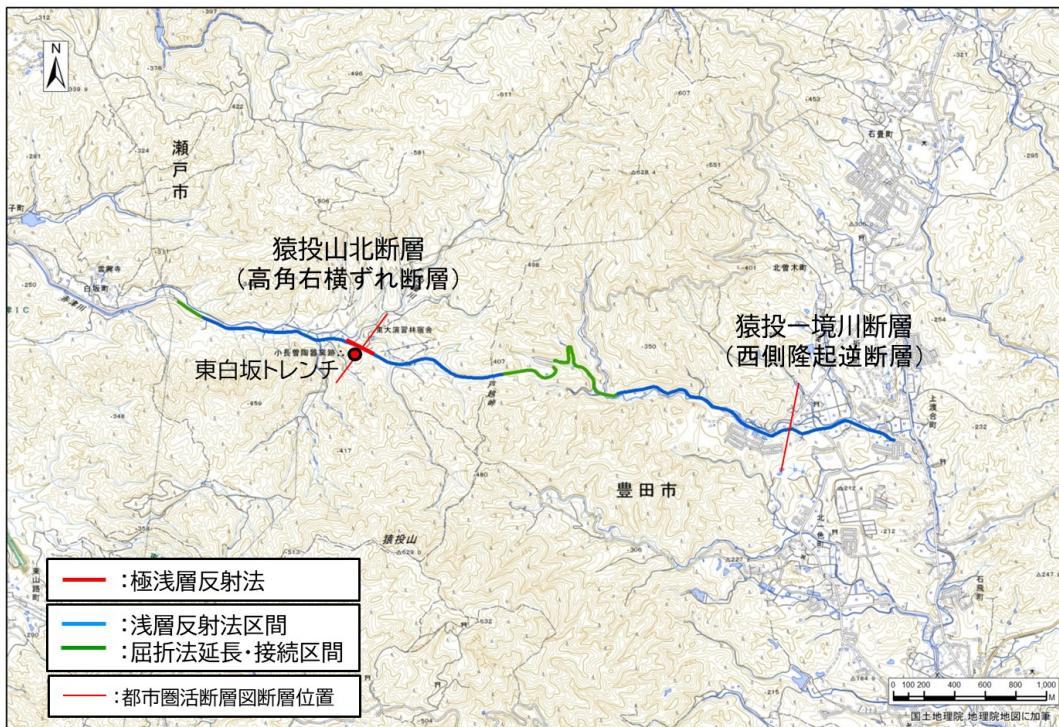
図2 測線1（長さ約 5.4km）。国土地理院の地理院地図に都市圏活断層図（岡田・他, 2017）の断層の地表トレースを参照して加筆。
