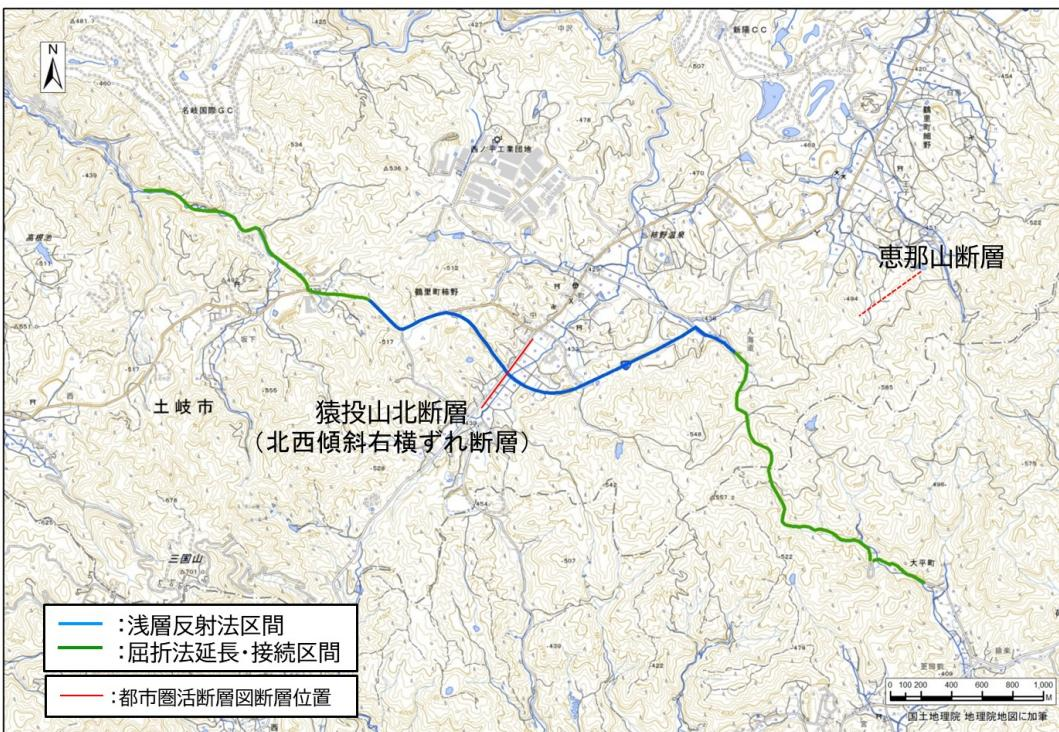
図3 測線2（長さ約 7.0 km）。国土地理院の地理院地図に都市圏活断層図（岡田・他, 2017）の断層の地表トレースを参照して加筆。
