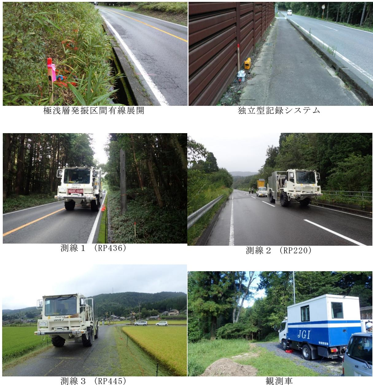
図5 現場での観測の状況（写真は（株）地球科学総合研究所提供）。RP は受振点位置（番号）を表す。
