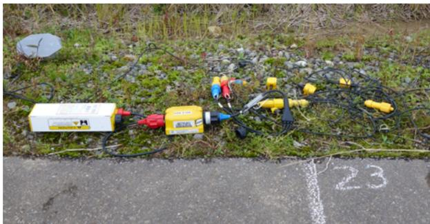
図 42 独立型地震波収録器の例。黄色・白色の箱形の機器が収録器とリチウムイオン電池。ここでは受振点 1 箇所につき地震計 3 台のバンチングを行い、1 ch の収録を行っている。
