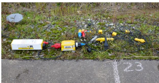
図17 独立型地震波収録器の例。
