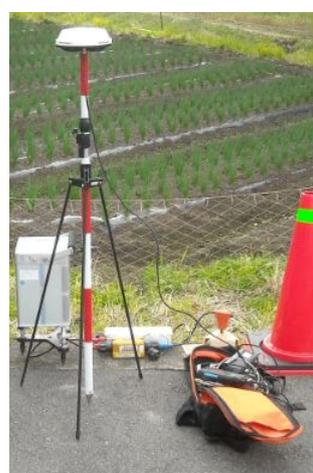
図16 Hemisphere社製 RTK-GPS装置
