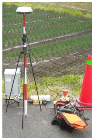
図2 Hemisphere 社製 RTK-GPS 装置
