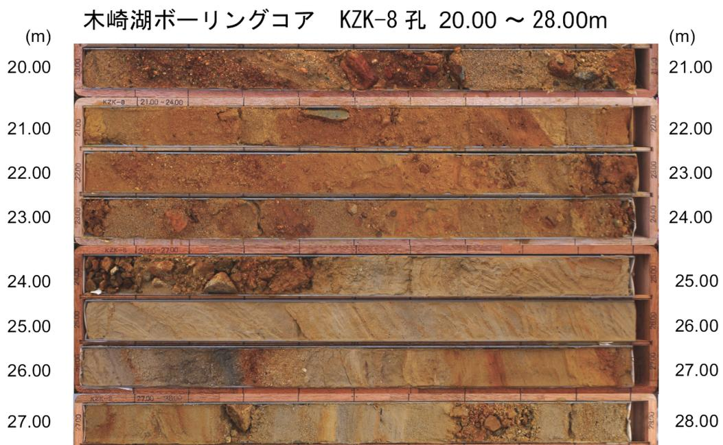
図 105 KZK-8 孔のボーリングコア写真 (続き)。掘削位置は図 101 に示す。
