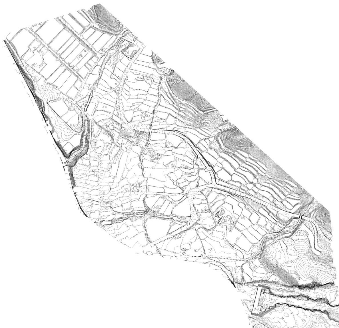
図 12 下葛木断層周辺のドローン LiDAR による等高線図
