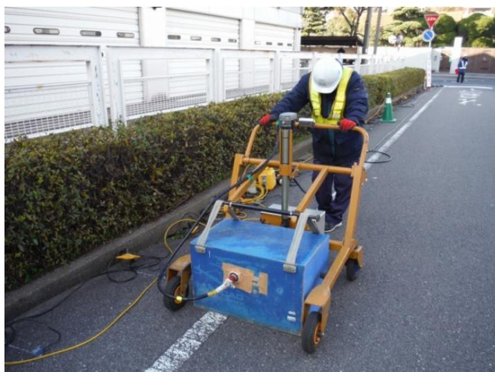
図 38 ポータブルバイブレータ
