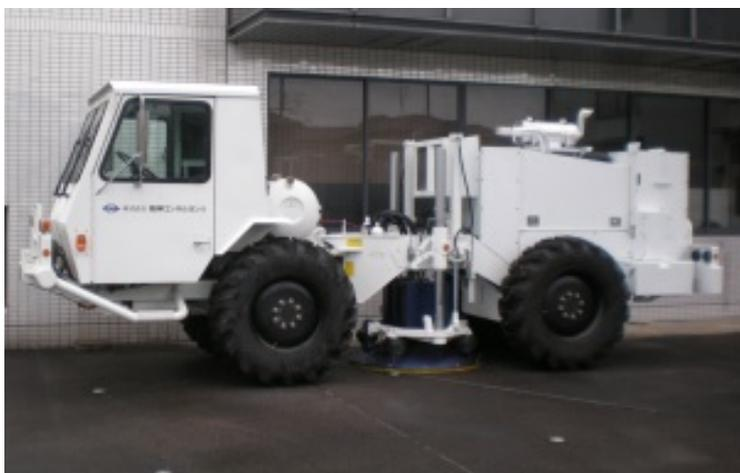
図 127 中型バイブレーター震源
