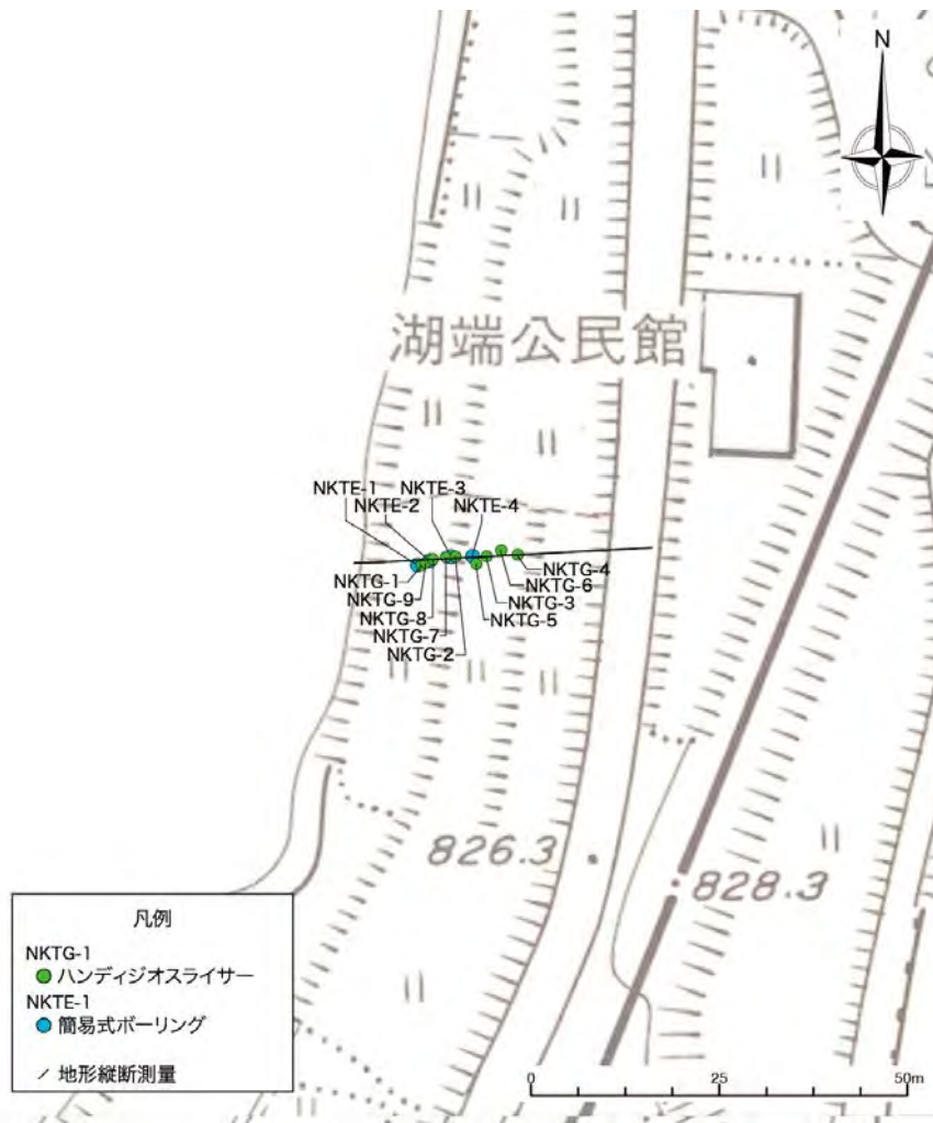
図 11 中綱湖周辺におけるジオスライサー調査地点の詳細位置図。基図は大町市発行の 1/2,500 都市計画図。NKTG-1～9 及び NKTE-1～4 はハンディジオスライサーおよび簡易式ボーリングの位置。黒線は地形断面測線の位置
