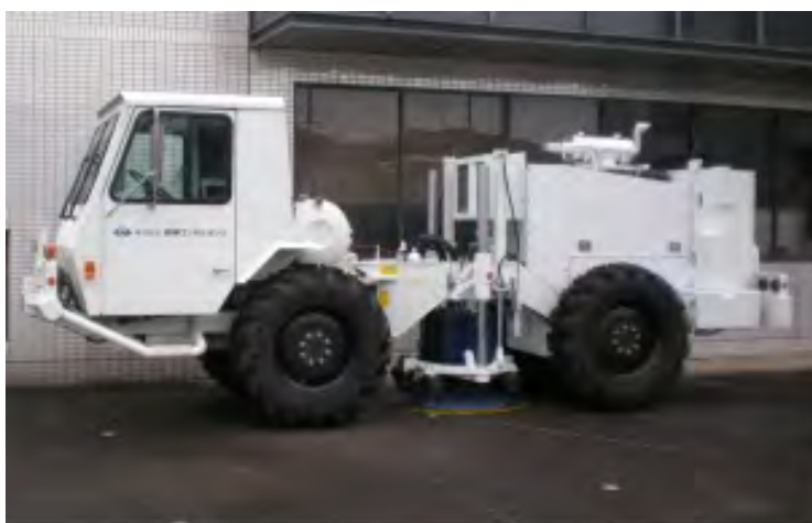
図 43 中型バイブレーター震源
