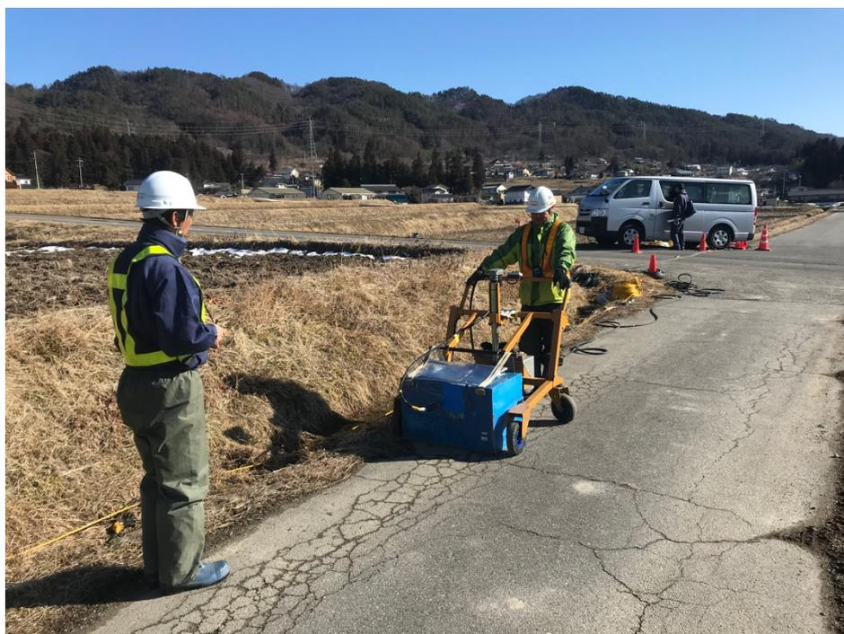
長野県北安曇郡池田町会染周辺において松本盆地東縁断層北部のS波極浅層反射法地震探査を実施し、地震時変位量をより正確に復元するための断層構造等を明らかにした。
