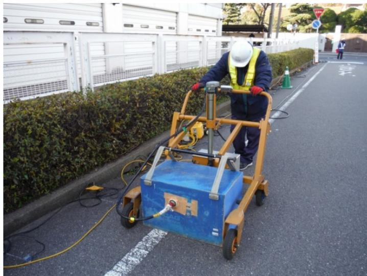
図 11 ポータブルバイブレータ
