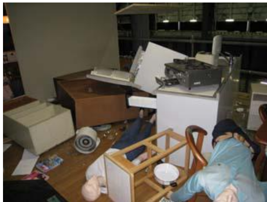
図 2.11 集合住宅のキッチンの状況（左：家具転倒対策なし，右：対策あり） （榎田・他，2009）。
