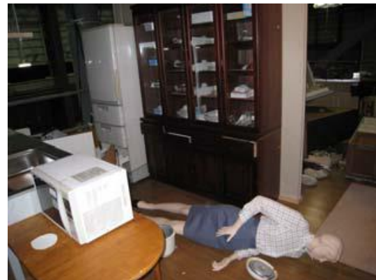
図 2.11 集合住宅のキッチンの状況（左：家具転倒対策なし，右：対策あり） （榎田・他，2009）。
