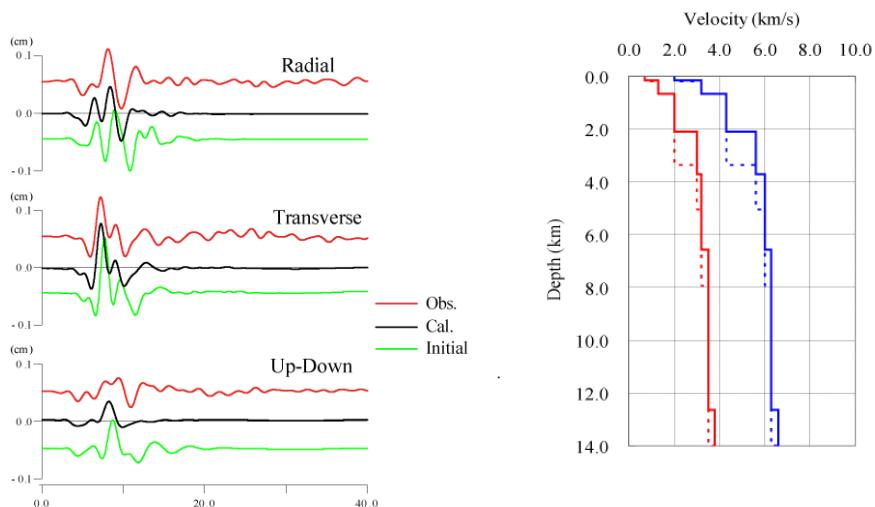
観測波形と地震動シミュレーションによる波形の比較および速度モデルの修正結果
