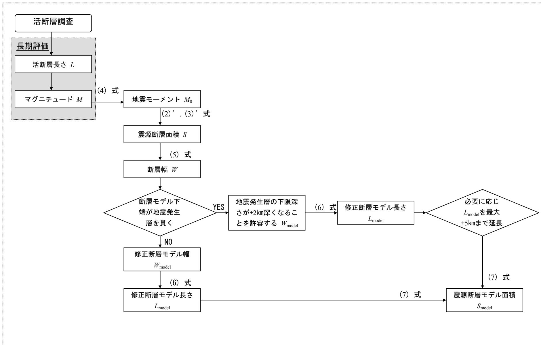
付図3 活断層で発生する地震の震源特性パラメータ設定の流れ
