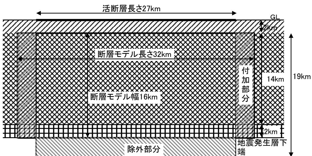
断層モデル長さおよび幅の概念図
