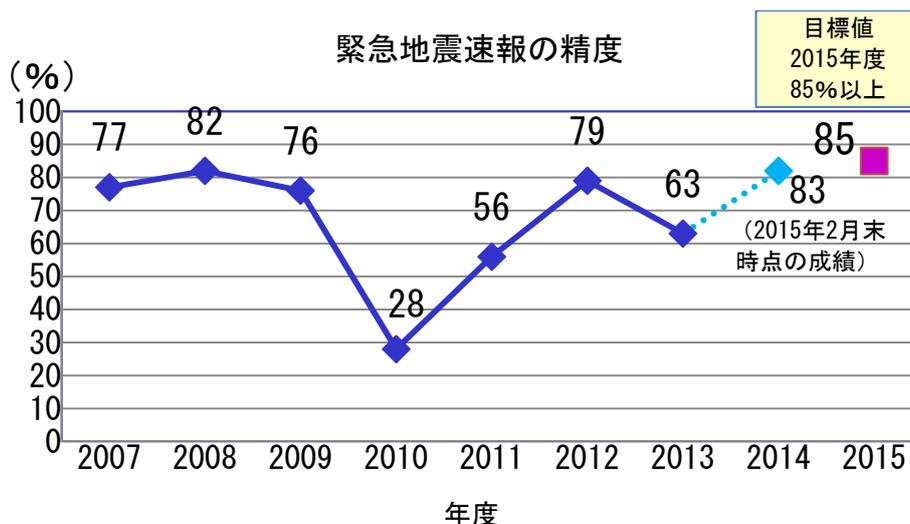
図3 震度4以上を観測または予測した緊急地震速報についての精度の経年変化。2010年度から2011年度にかけては東北地方太平洋沖地震(2011/3/11)の余震多発により精度が大きく低下した。
