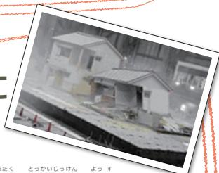
木造住宅の倒壊実験の様子
