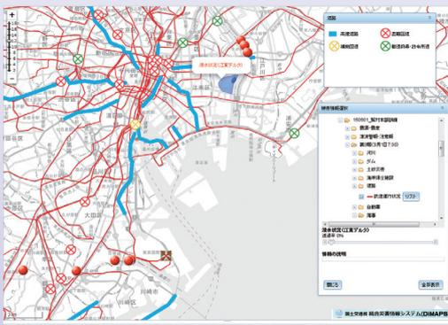
被害情報の表示例（平成 27 年度国土交通省地震防災訓練の情報。赤丸は河川、青線は高速道路、赤線は鉄道の被害情報。青の多角形は作図された浸水範囲）
