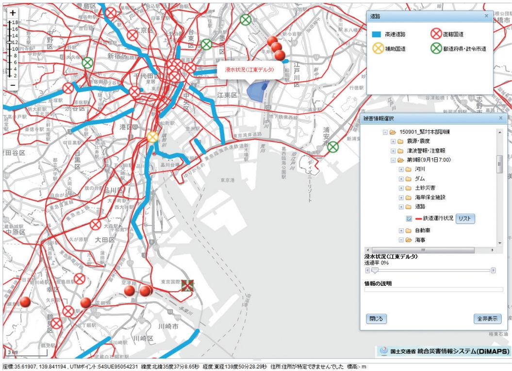
図3 被害情報の表示例（平成27年度国土交通省地震防災訓練の情報。赤丸は河川、青線は高速道路、赤線は鉄道の被害情報。青の多角形は作図された浸水範囲）
