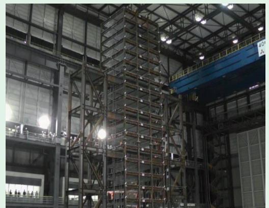
高層ビルの耐震性能評価のための モニタリング技術開発の実験（文部科学省実施）
