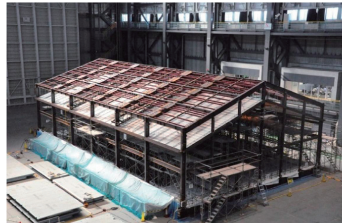
図5 体育館試験体の天井落下実験
