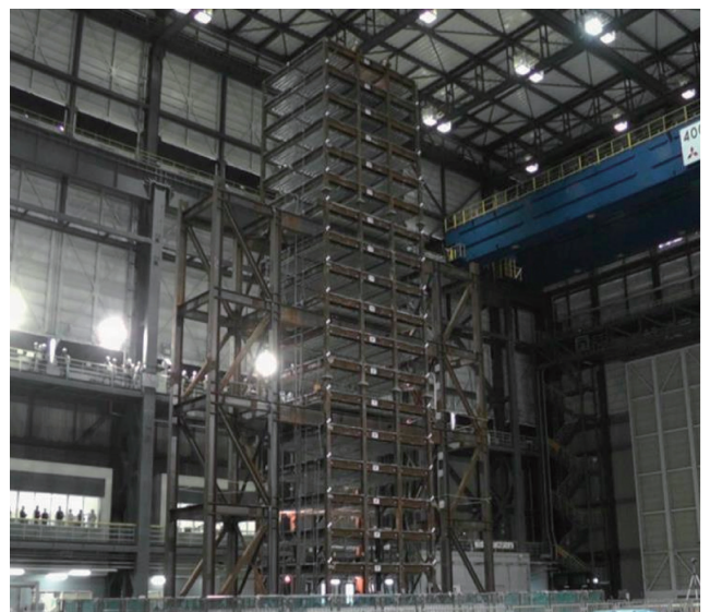
図2 高層ビルの耐震性能評価のためのモニタリング技術開発の実験(文部科学省実施)
