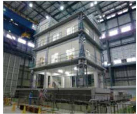
■ E-ディフェンスの試験に用いた4層免震建物
