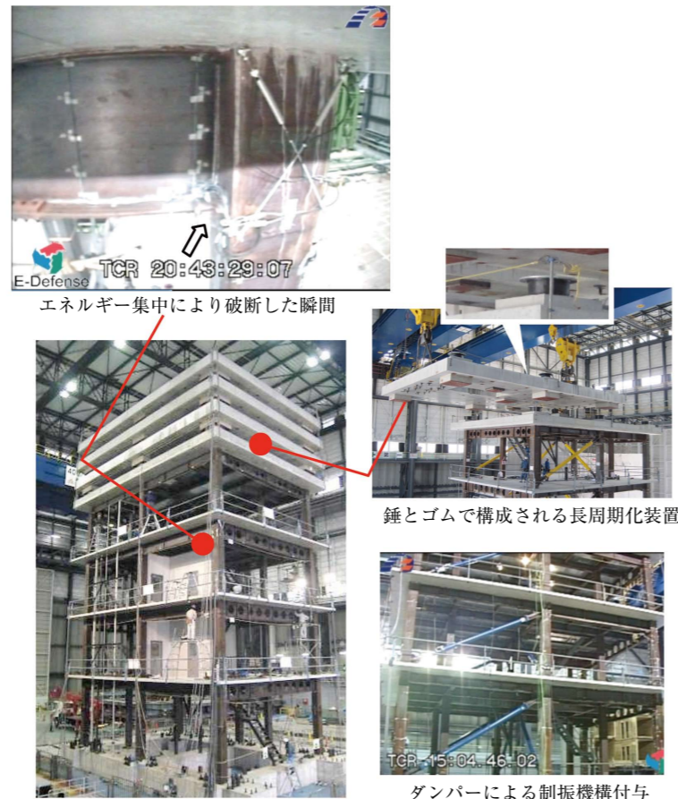
図2 骨組の耐震性と補強効果に関する実験
