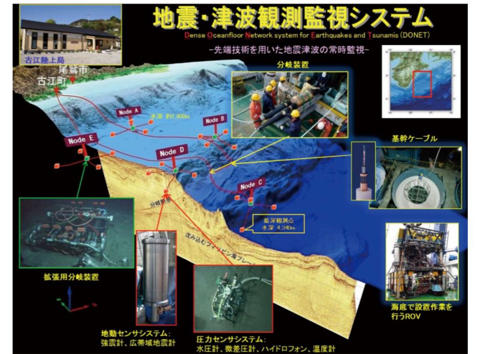
図2 地震・津波観測監視システム [DONET] 展開図
