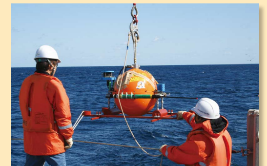
■ 東京大学地震研究所：海底地震計の設置風景
