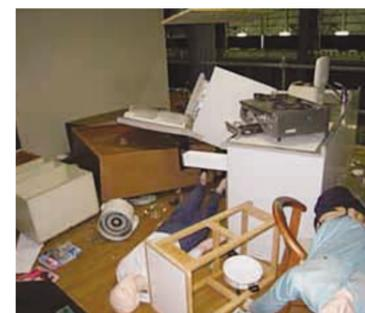
図7 E-ディフェンスによる実験 家具転倒対策をしていないキッチンの例
