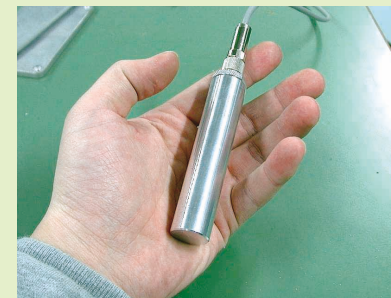
容量型マイクロ加速度センサを組み込んだ坑井内地震計 (国立大学法人東北大学大学院環境科学研究科 浅沼宏氏 提供)
