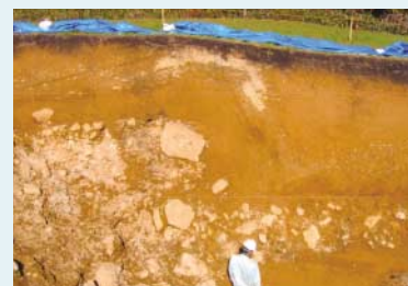
岩手・宮城内陸地震の震源域での活断層のトレンチ調査（独立行政法人産業技術総合研究所提供）
