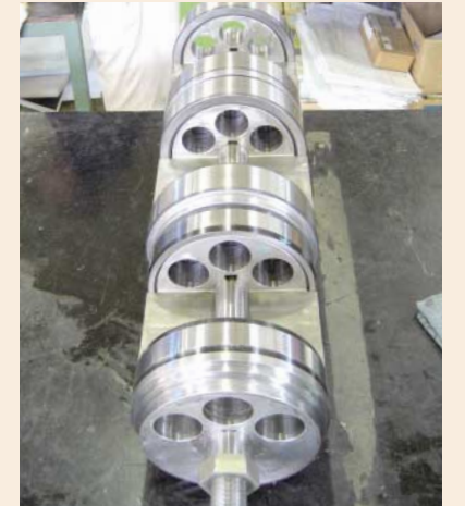
図2 アクロス震源装置の本体内部で回転するロータ部分の写真です。中心軸に対して偏ったおもりが取り付けられています。写真では、軸の下側に重量が集中していることがわかります。
