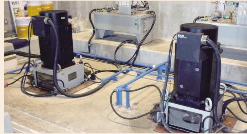
図1 淡路島に設置されているアクロス震源装置。偏心量の異なる2台の装置を用い、左側の装置は25Hzで200kN(ニュートン)、右側の装置は35Hzで200kNの力を発生させることができます。黒い部分はACサーボモーターです。おもりの入っている本体はコンクリートの基礎に1メートルほど埋め込まれて固定されています。本体の後ろにある装置は、潤滑油を循環させるためのポンプです。
