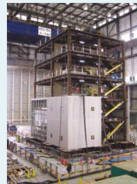
実大鉄骨建物に制振ブレースを設置した地震 応答の低減実験 （独立行政法人防災科学技術研究所提供）
