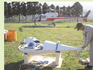
航空機を利用した、電磁気学的手法による地下構造探査の準備の様子。（国立大学法人 北海道大学大学院理学研究院 茂木透氏 提供）
