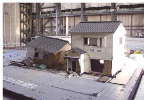
写真1 木造建物実験：補強しない住宅（左）、耐震補強を施した住宅（右）
