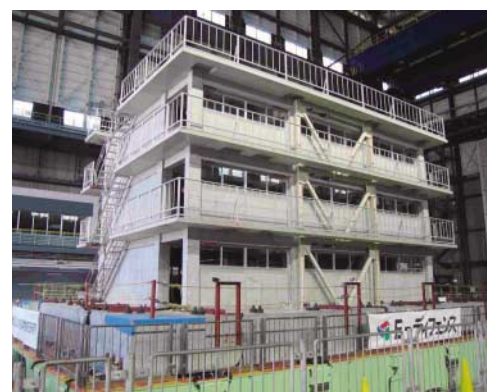
写真2 学校校舎の鉄筋コンクリート建物実験
