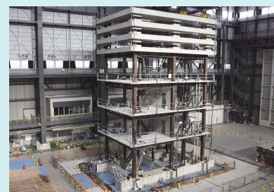
E-ディフェンスによる建物モデル地震動実験の試験体（独立行政法人 防災科学技術研究所兵庫耐震工学研究センター提供）
