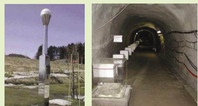
電子基準点 GPS連続観測を行う基準点です。 水管傾斜計 地盤の傾斜を精密に連続観測しています。
