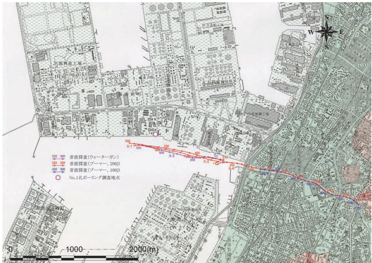
図 55 石津川における音波探査およびボーリング調査の位置。基図は、国土地理院発行 1:25000 都市圏活断層図「大阪西南部」(中田ほか, 1996)。
