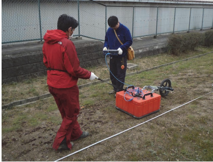
図 28 地中レーダー探査プロファイル測定法でのデータ取得の風景。アンテナ後方のサーベイホイールによってアンテナの移動と電磁波の送受信を同期させ、1 cm 間隔のスキャンを行う。
