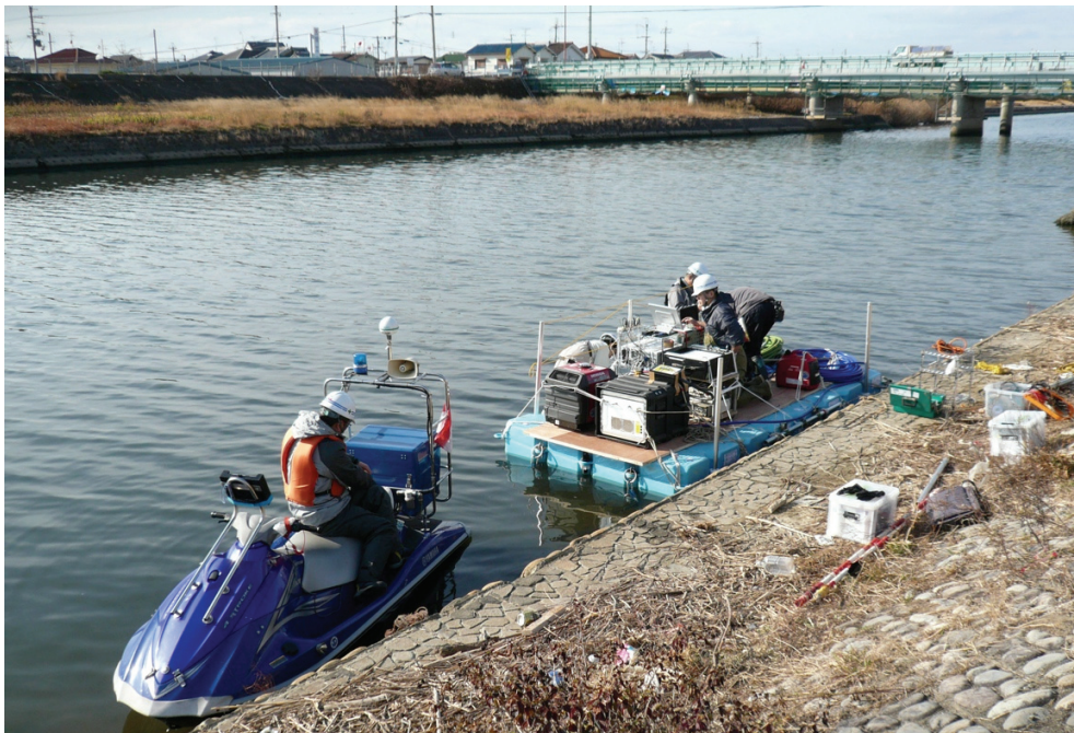
泉南市、田尻町の檜井川における音波探査風景 水上バイクによってフロート台船、ブーマー音源とストリーマーを曳航した。
