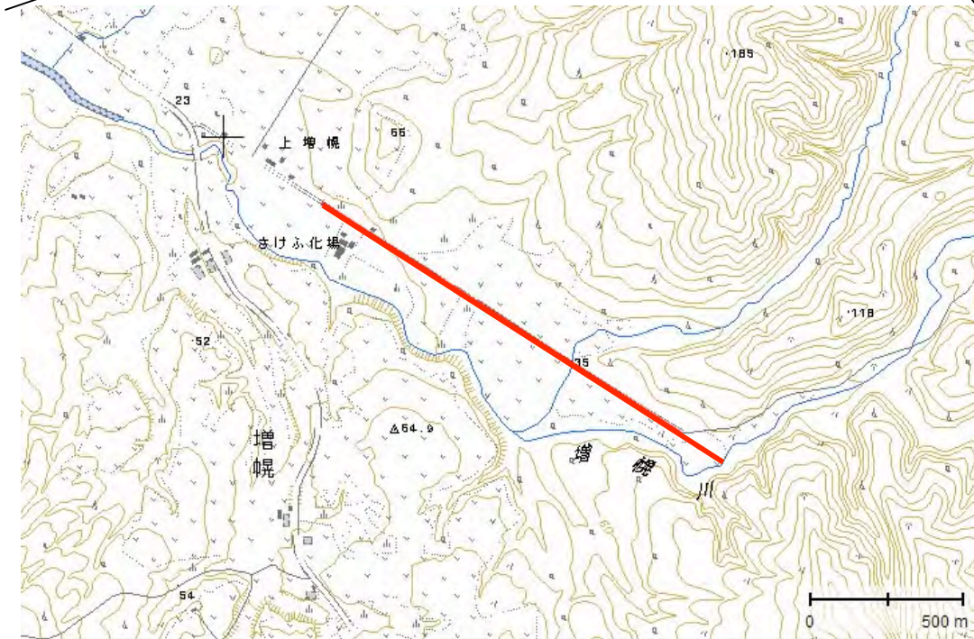
図2 反射法地震探査の測線位置図(測線:赤色線). 基図は, 国土地理院発行数値地図 25,000 地図画像「稚内」のうち「声間」を使用.
