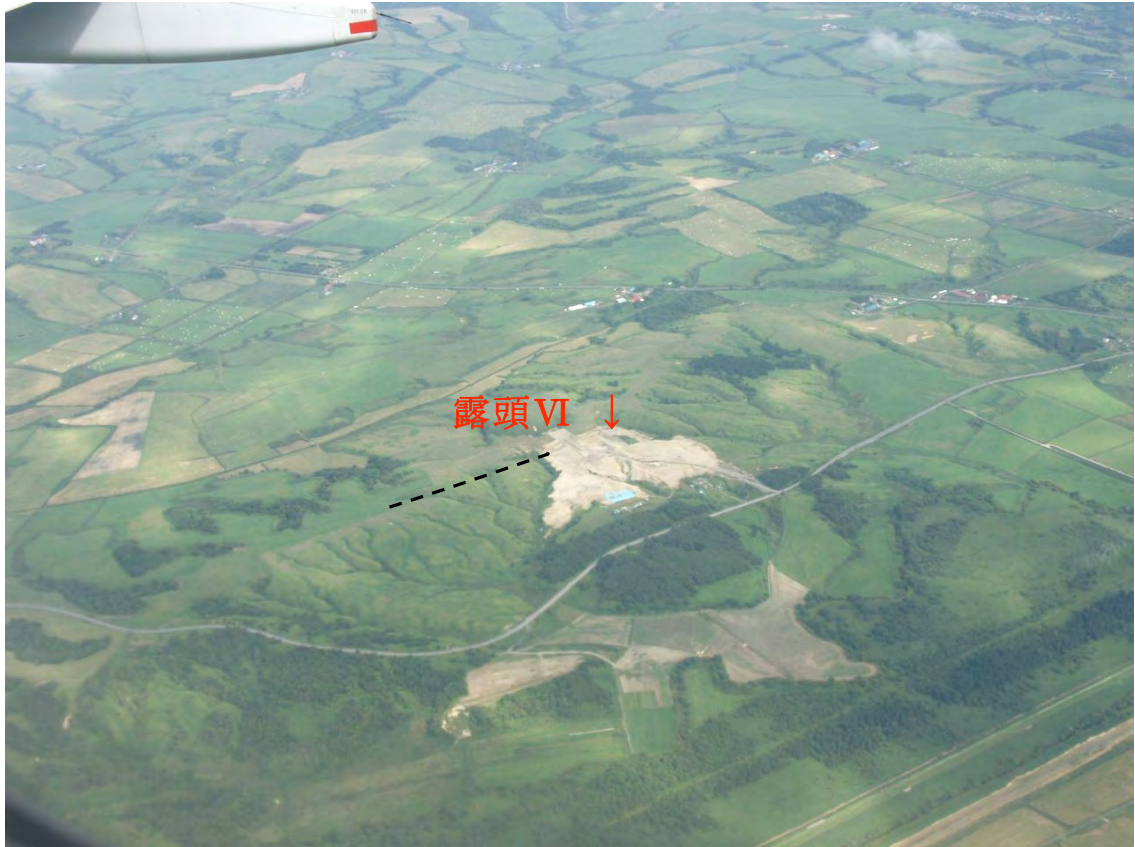
図 29 露頭VI周辺の斜め空中写真（矢印が露頭位置） 源頭部で北西方向に屈曲する水系の位置を破線で示す。
