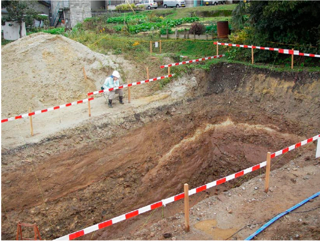
図4 山見トレンチの写真。南西から北東方向を見る。写真奥が撓曲崖。
