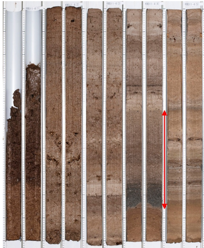
図 14. コア KMD11-4 の写真。左上が最上部、右下が最下部、コア脇の目盛は 1 cm で全長 473cm。1 本のコアを縦に半割し、見開いた形の写真となっている。赤矢印の部分が約 2000～2300 年前のイベント層。
