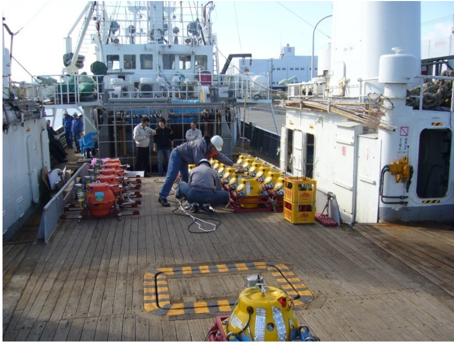
図1 海底地震計及び水圧計の準備作業風景。黄色いケースに納められているのが海底地震計、橙色のケースに収められているのが水圧計。
