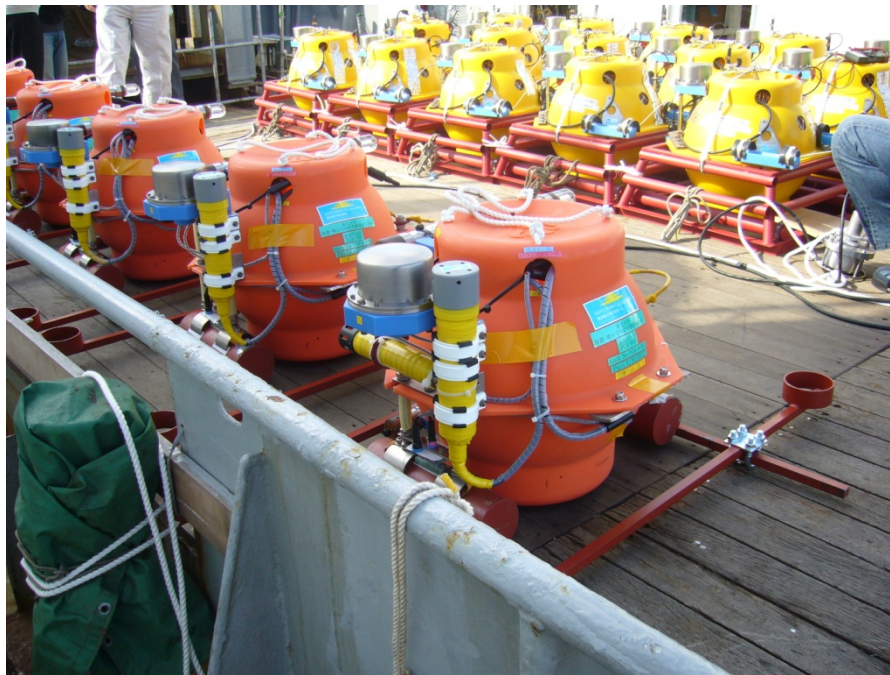
図2 海底水圧計。橙色のケース内に電源電池とデータ収録装置を納めた17インチ耐圧ガラス球が入っている。圧力センサーと精密温度計は、耐圧容器の外側に取り付けられている。
