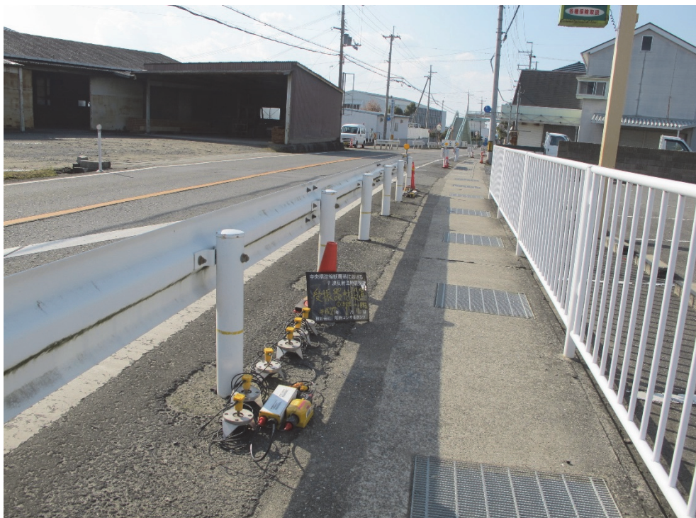
和歌山－紀ノ川測線での受振機材設置状況
