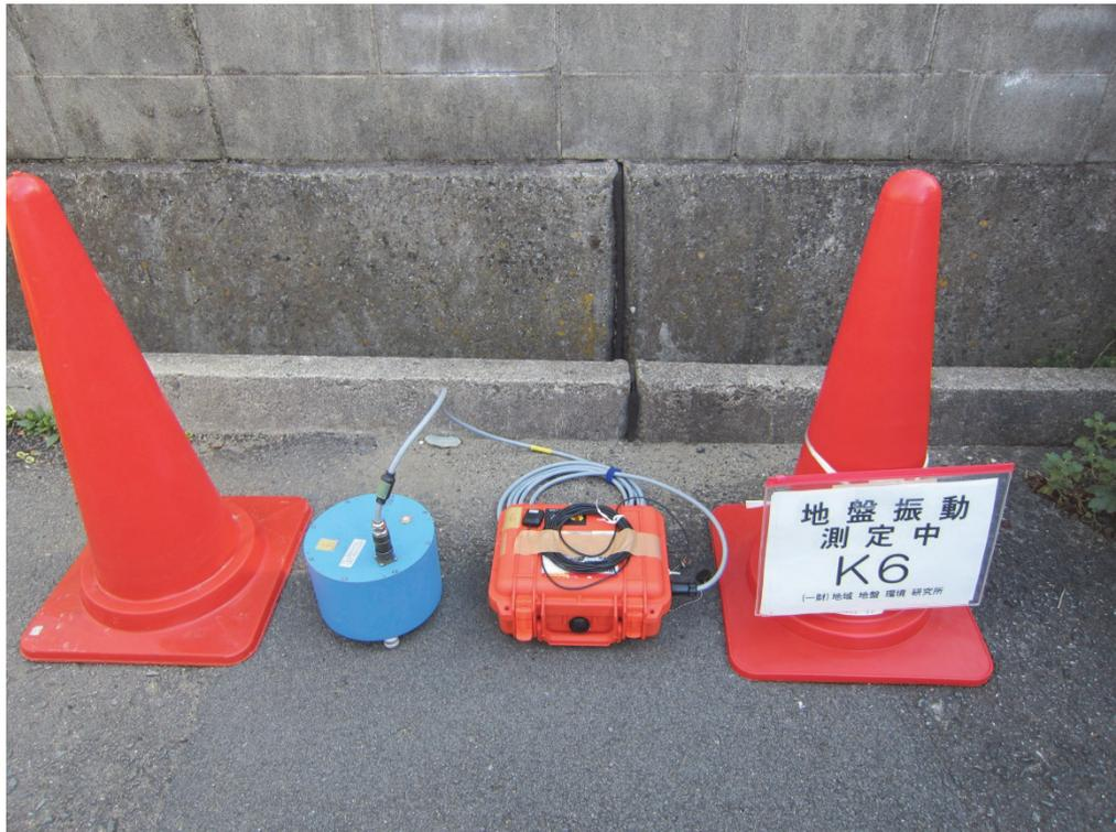
写真1 微動アレイ観測点の現場状況（梶取、K6地点）。青色の円筒状の筐体が地震計、隣のオレンジ色の筐体がデータ記録器。
