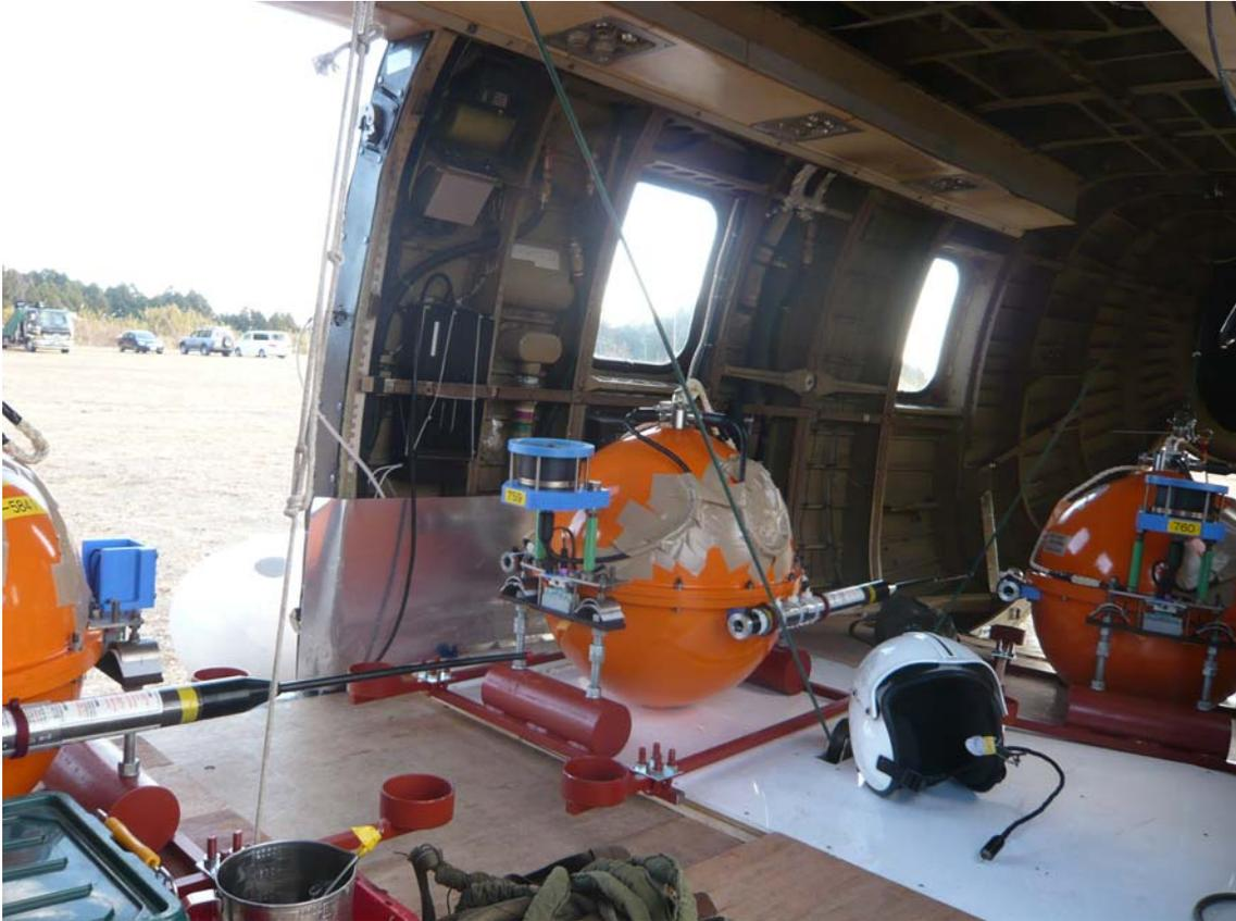
写真4 設置直前の新規長期観測型海底地震計
