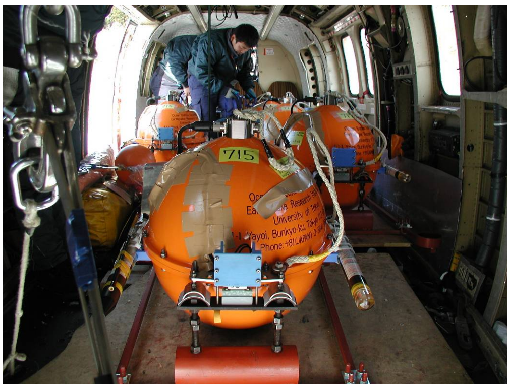
写真8 大型ヘリコプター機内に搭載した5台の長期観測型海底地震計
