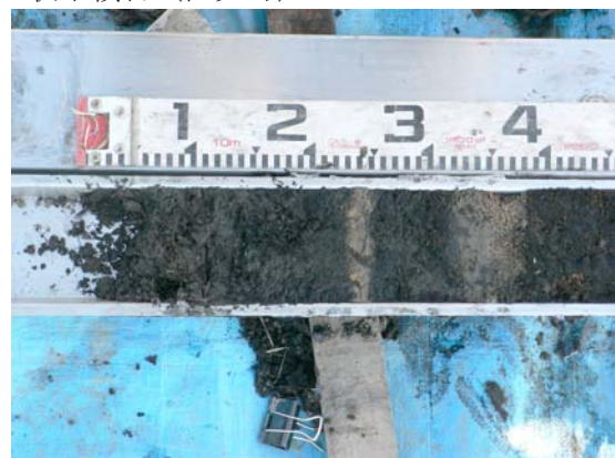
小型ジオスライサーを用いて採取された柱状 堆積物（亶理町）
