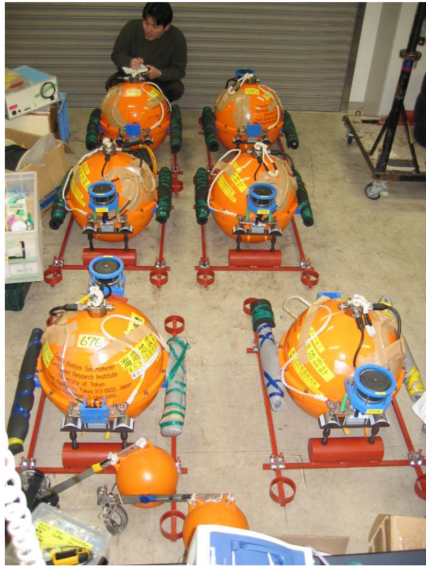
写真5 組み上げた海底地震計5台（図中6台の内の5台が宮城沖重点観測用）
