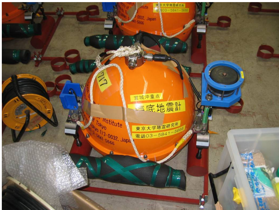
写真4 組み上げの完成した長期観測型海底地震計 宮城沖重点観測用の海底地震計であることを示すラベルを、チタン製耐圧容器の表面に貼って完成。
