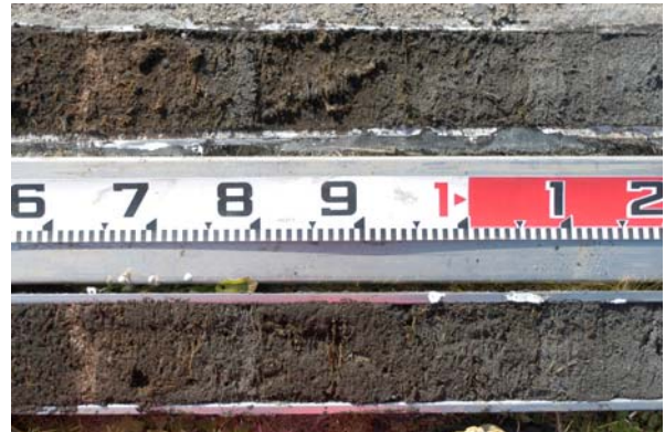
小型ジオスライサーを用いて採取された柱 状堆積物（山元町）
