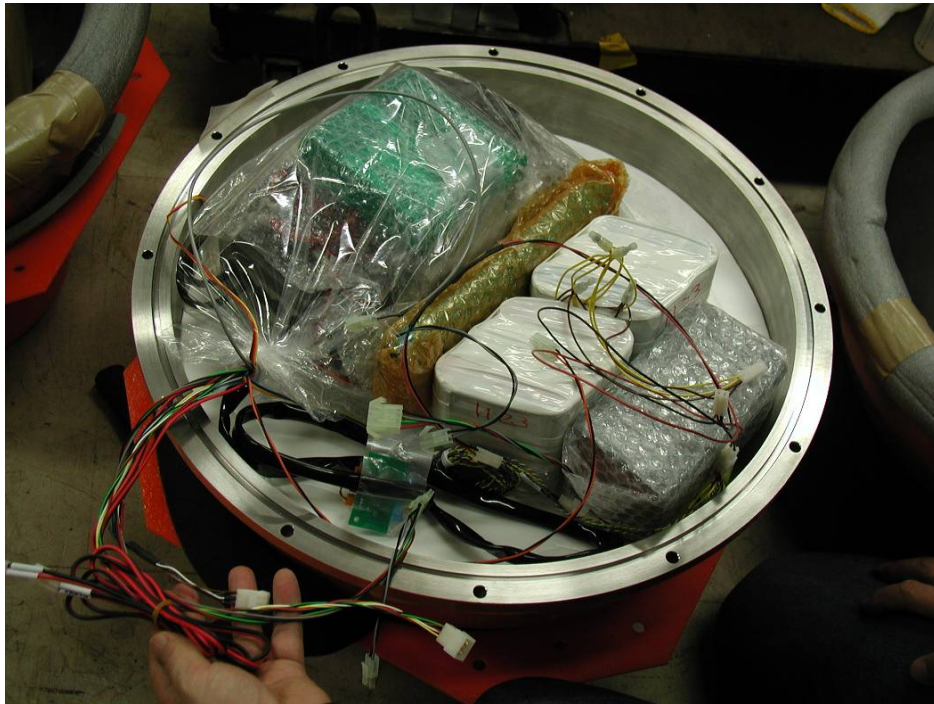
写真3 長期観測型海底地震計の組立作業 チタン製耐圧容器下半球への、レコーダー、電池等の組み込み作業。
