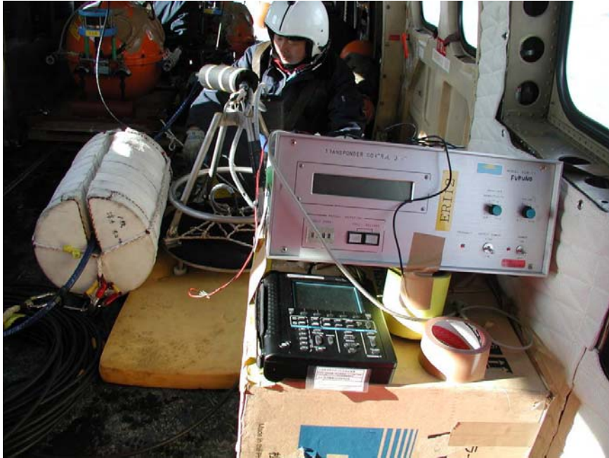
写真9 ヘリコプター機内に搭載された海底地震計の海底設置位置測定システム
