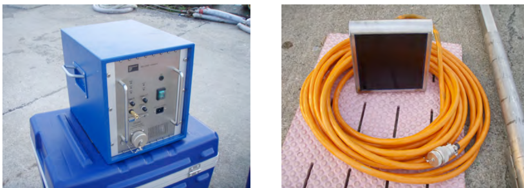
図 5-7 SES2000 システム外観 (左：制御装置 右：送受波器)
