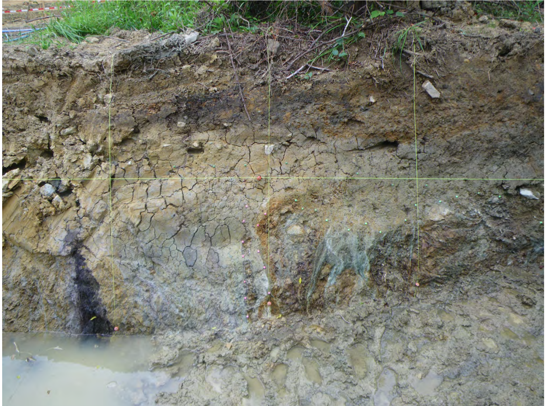
図13 後山Cトレンチ北壁面断層部分の写真 ピンクのピンが断層. グリッド間隔は1m.
