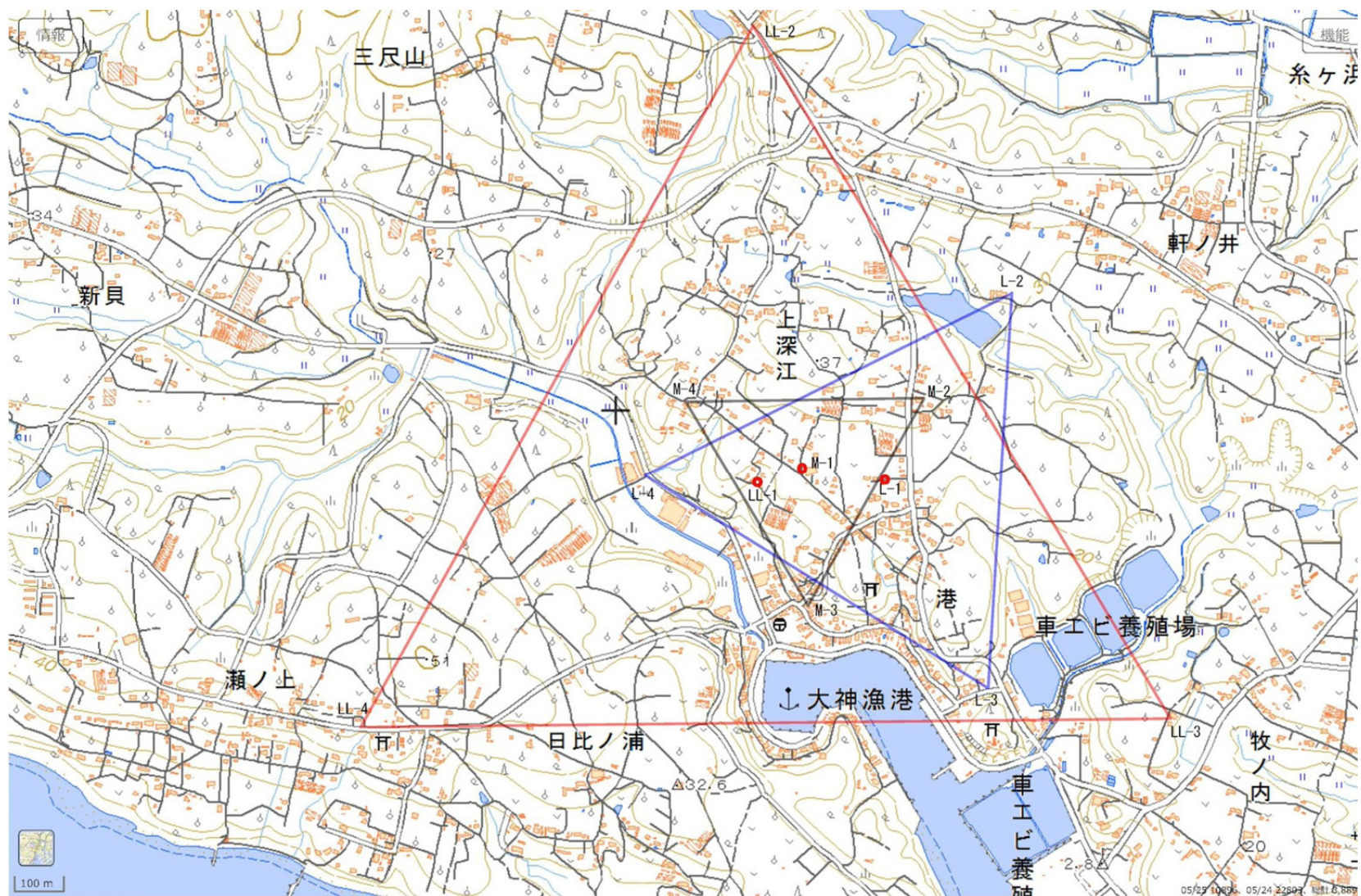
大アレイ配置図 (HJO : 日出大神地区) LLアレイ : 底辺長 1700m、Lアレイ : 底辺長 850m、Mアレイ : 底辺 図 3.3.1-4 HJO (日出町大神地区) アレイ観測点配置図 (観測点は三角形の頂点と重心位置)
