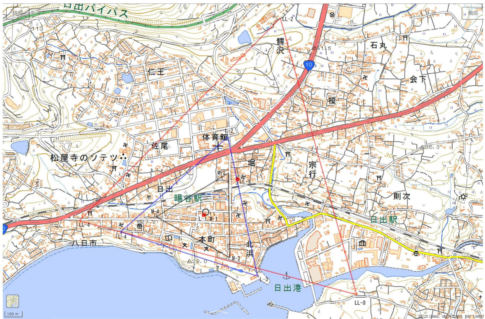
大アレイ配置図 (HJI: 日出地区) LLアレイ: 底辺長 1700m、Lアレイ: 底辺長 850m、Mアレイ: 底辺長 500m、 図 3.3.1-3 HJI (日出町中心部) アレイ観測点配置図 (観測点は三角形の頂点と重心位置)
