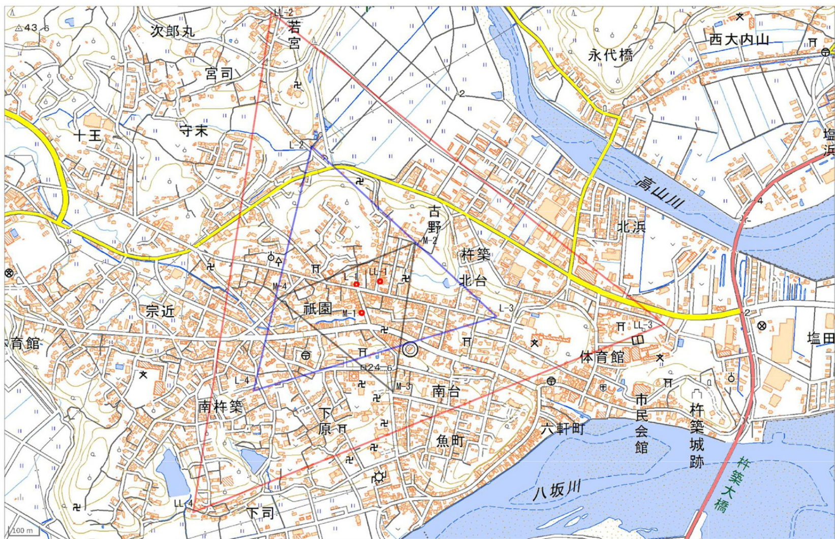
大アレイ配置図 (KTK: 杵築地区) LLアレイ: 底辺長 1700m、Lアレイ: 底辺長 850m、Mアレイ: 底辺長 500m、 図 3.3.1-5 KTK (杵築市中心部) アレイ観測点配置図 (観測点は三角形の頂点と重心位置)
