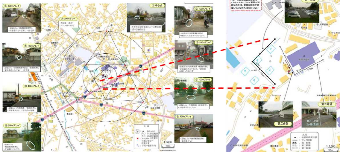
図5-2-3 大アレイの例（半径R=400, 200, 100mの三角形アレイ、一辺75, 50, 25mのL字アレイ）
