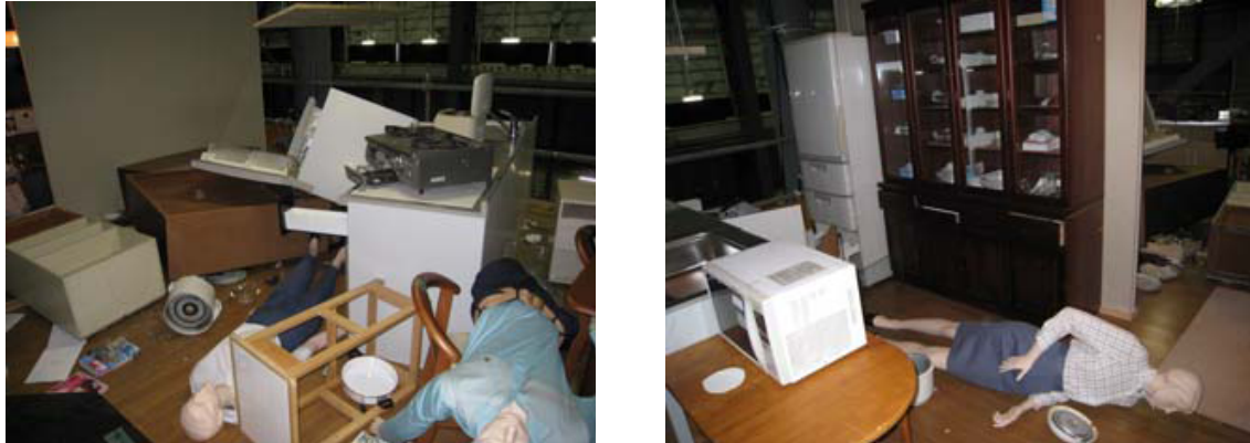
図 1.8 集合住宅のキッチンの状況（左：家具転倒対策なし，右：対策あり） （榎田・他，2009）
