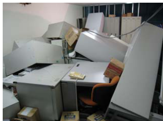
図 1.7 オフィスの状況（左：加振前，右：加振後）（榎田・他, 2009）
