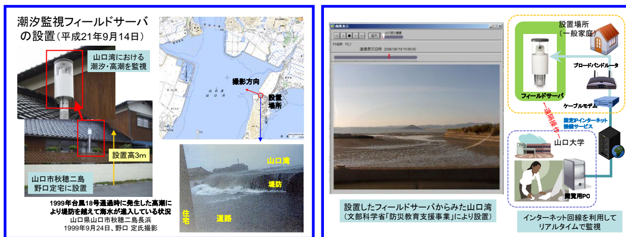
図1 高潮・潮汐監視を目的としたフィールドサーバの設置と運用
